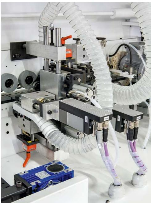
● Gruppo raschiatore DIGIT O2 con nebulizzatore di liquido anti-adesivo.
